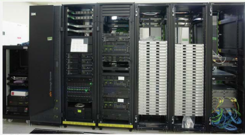
ラック1 自動化 ラック2 ディスクアレイ ラック3 ファイルサーバ 仮想化サーバ プリントサーバ ラック4 サイレンスサーバ 利用統計 高速計算サーバ 統合サーバ2台 ブートサーバ50台 検証用1台 迷惑メールフィルタ ネットワークSW
